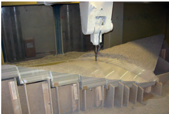
Abb. 5: Herstellung eines Sandwichkerns mittels CNC-Fräsmaschine.
