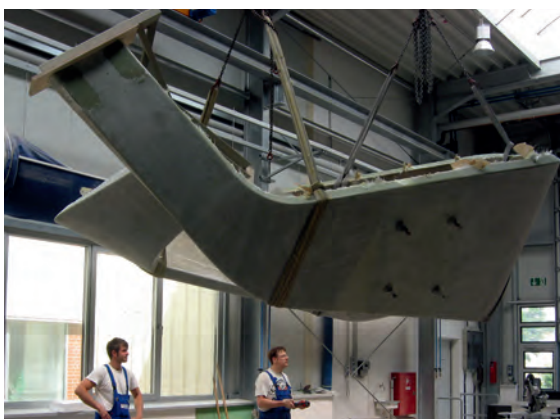
Abb. 6: Flügel mit eingebettetem Lasteinleitungselement vor dem Flächenfinish und Lackieren.
